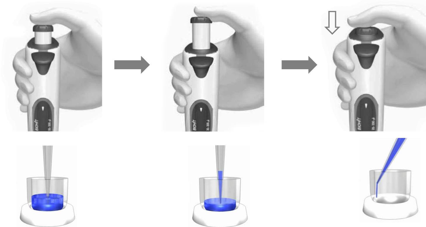
Нажмите на операционную кнопку до второго упора и опустите наконечник в жидкость на глубину 2-3 мм.
