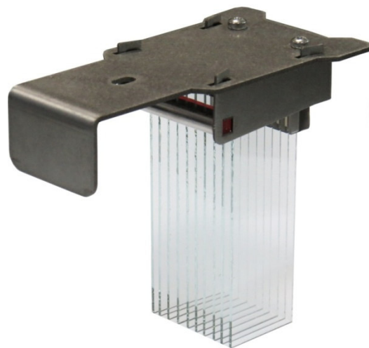
Штатив АФОМК-16 на 10 предметных стёкол (верхнее крепление стёкол, штатив не погружается в растворы)
